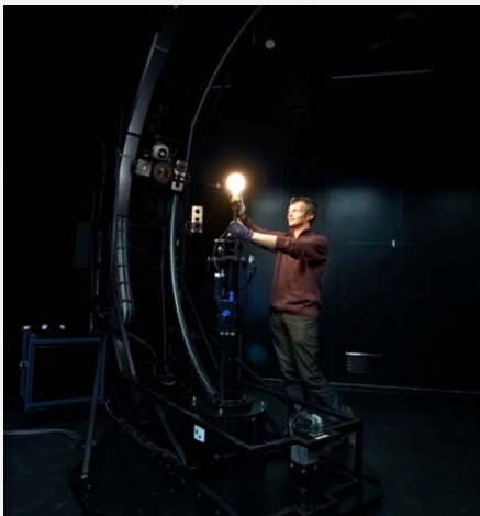
3m virtuel integrerende bol (meest nauwkeurig, hoekopgelost)
